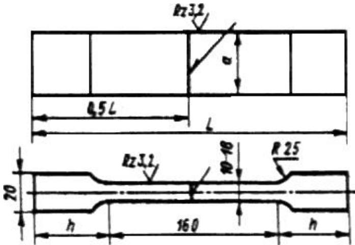
$a$  - толщина основного металла в мм
