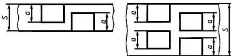
$S$  - толщина сварного соединения;  $\alpha$  - толщина образца
