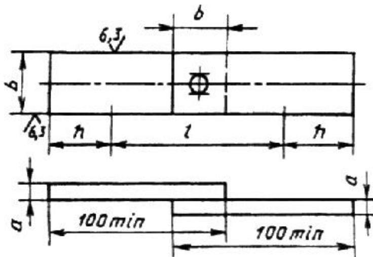
$a$  - толщина основного металла, мм;  $h$  - длина захватной части (выбирают в зависимости от конструкции испытательной машины), мм;  $l$  - длина рабочей части образца, мм
